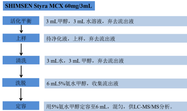
图 2 样品净化流程图
